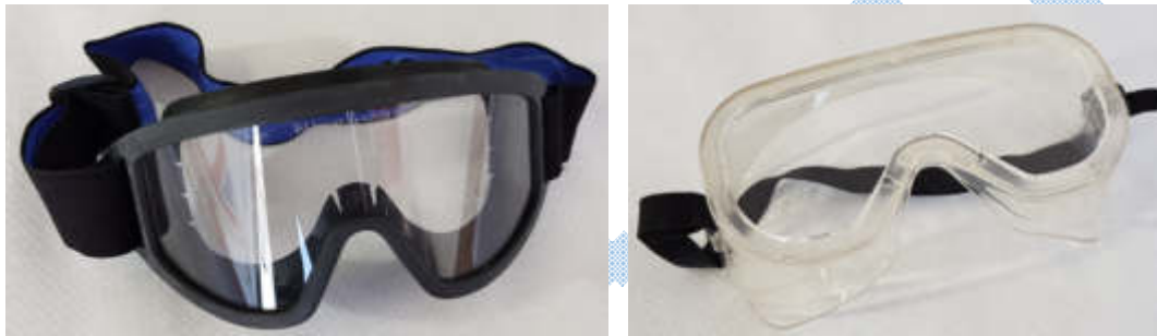
Geschlossene Vollsichtschutzbrille bei Aerosolbildung nach Kategorie III, EN 166, EN 170, beschlagfrei nach EN 168-16, passend zur Halbmaske, ggf. hohe Ausführung für Brillenträger.
